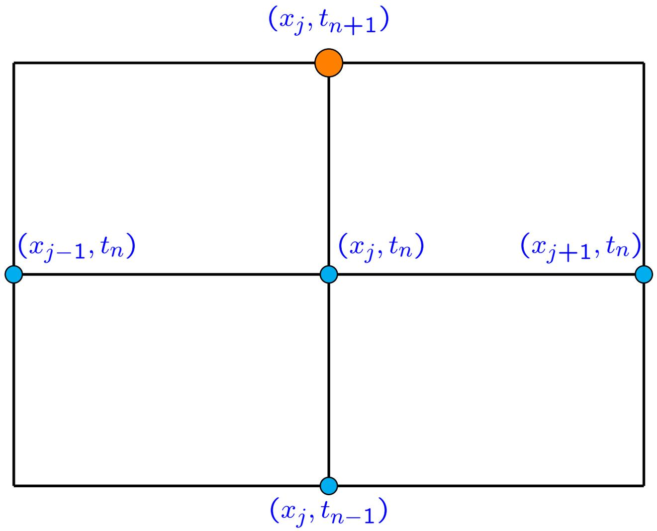
Il primo insieme di valori che è possibile calcolare è  $u_j^2$ , però è necessario anche conoscere  $u_j^1$ , poichè i valori  $u_j^0$  sono forniti dalla conoscenza della condizione iniziale
