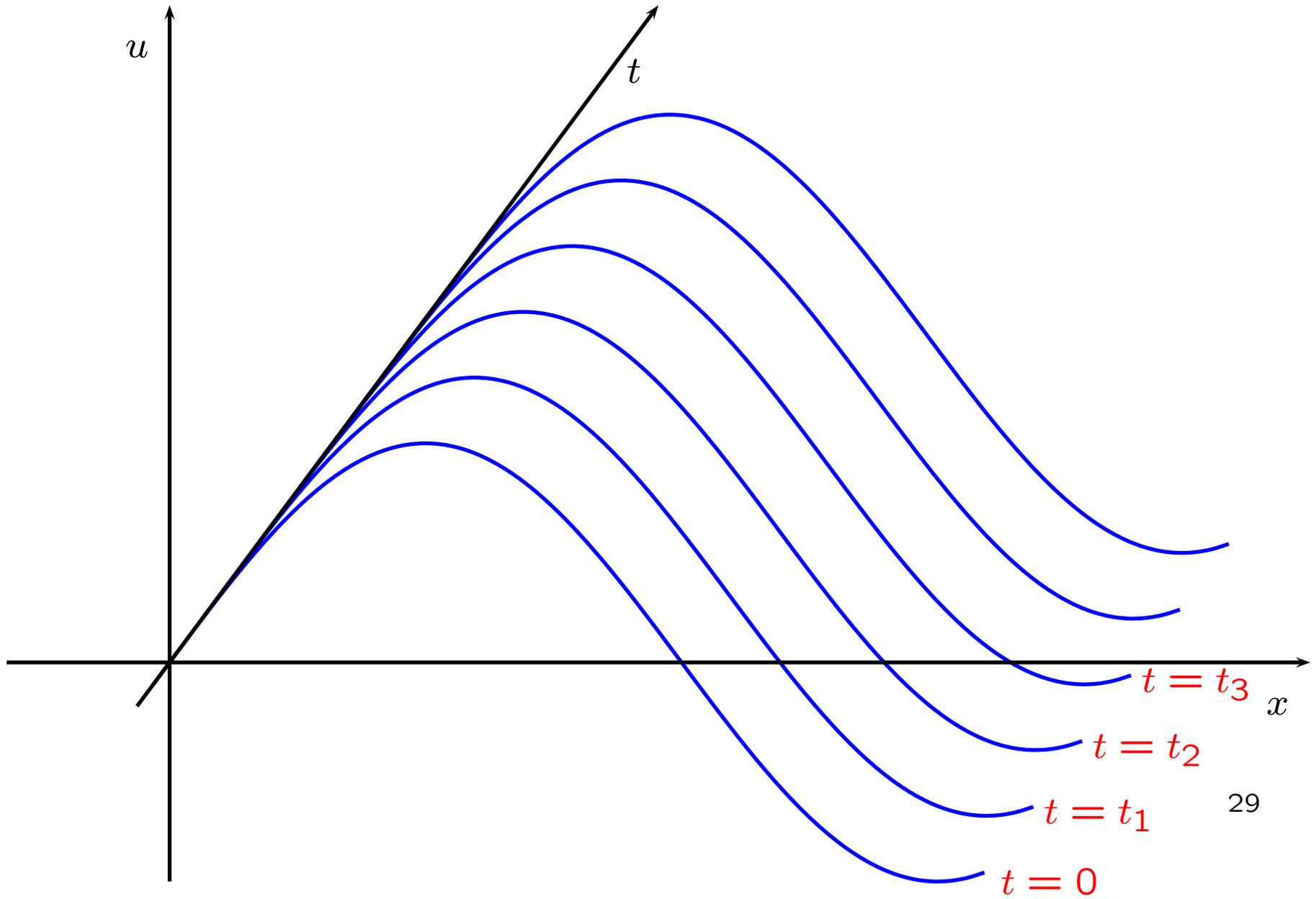
Se la condizione iniziale è discontinua (per esempio presenta un salto) allora anche la discontinuità si propaga alla medesima velocità dell'onda.
