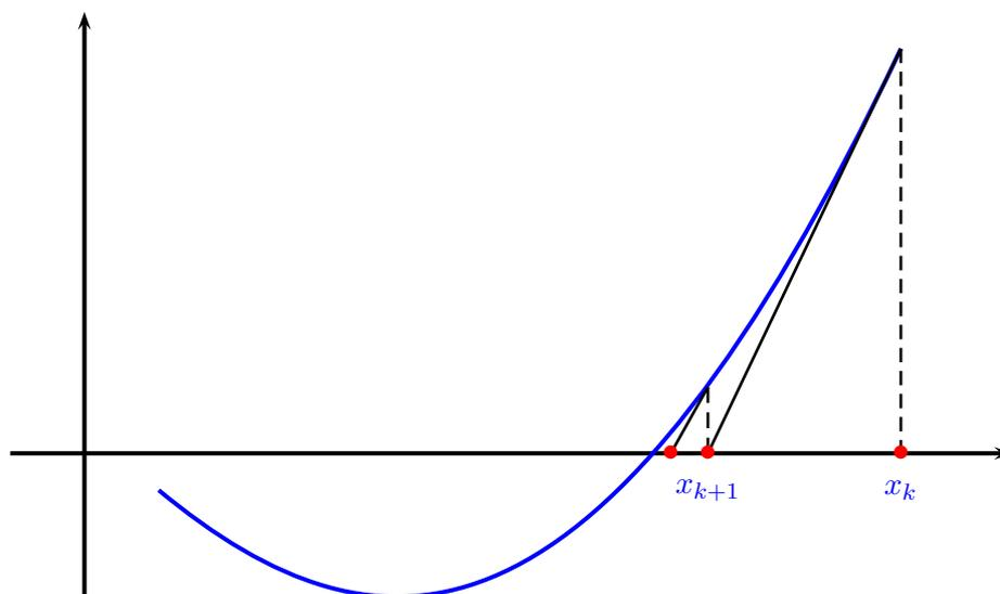
Per ricavare la funzione iteratrice del metodo consideriamo l'equazione della retta tangente alla funzione  $y = f(x)$  nel punto di coordinate  $(x_k, f(x_k))$
